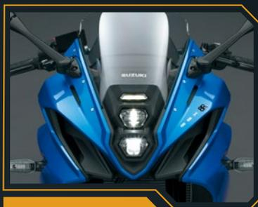
El par de faros LED hexagonales apilados verticalmente y rematados por una luz de posición LED contribuyen a crear una cara frontal esbelta y compacta con un atractivo futurista que simboliza el diseño Suzuki. Es un diseño afilado con un carácter único que hace que la cara frontal parezca ligera y lista para la acción. Montado en el chasis mediante el carenado, el conjunto del faro contribuye a la agilidad y a una sensación de dirección neutral de la GSX-8R.
