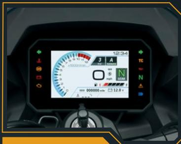
La GSX-8R adopta un panel de instrumentos multifunción TFT LCD a color de 5 pulgadas personalizado. Las pantallas de información de alta calidad, claramente legibles, te mantienen al tanto de todos los sistemas y ajustes de la moto, y te proporcionan información vital sobre el estado de funcionamiento en tiempo real.
