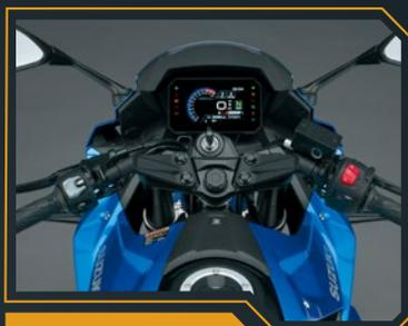
La disposición ergonómica de los interruptores maximiza la facilidad de manejo y la eficiencia para que puedas acceder a todos los controles mientras te concentras en la carretera. Selecciona los modos y realiza ajustes y configuraciones para cada sistema de control S.I.R.S. simplemente accionando los interruptores MODO y ARRIBA/ABAJO del manillar izquierdo.
